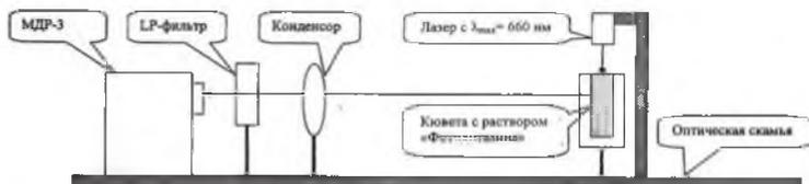
Рис. 2.5. Экспериментальная модель для измерения спектров флюоресценции препарата «Фотодитазин»
